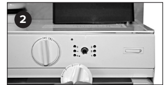
Nupin alla on säätö- ja mittausreiät
