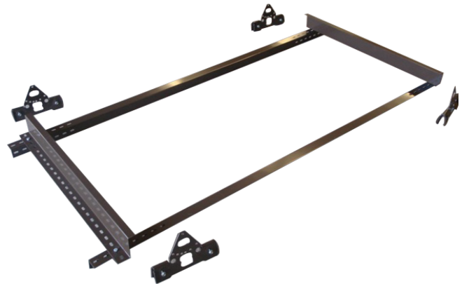
Kerääjä asennuskehikko kasattuna. Päätökappaleet asetetaan siten, että niiden pystyseiniä väliin jäävän kerääjän tilan pituus on 2 m.
