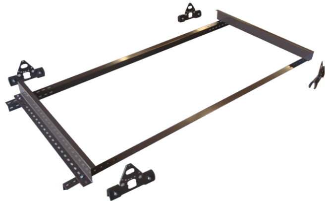
Kerääjä asennuskehikko kasattuna. Päätykappaleet asetetaan siten, että niiden pystyseiniä väliin jäävän kerääjän tilan pituus on 2 m.
