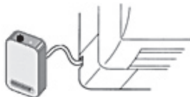
Rysunek 4.- Miejsce montażu urządzenia IntesisHome®
