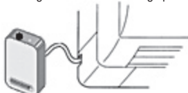
Abb. 4.- Positionierung von IntesisHome® an der Klimaanlage
