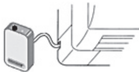
Figure 4.- IntesisHome®-apparat og AC-plassering
