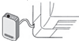
Figur 4.- IntesisHome®-enhedens og klimaanlæggets placering
