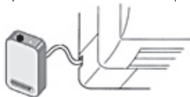
Figure 4.- Emplacement du module IntesisHome® par rapport au climatiseur
