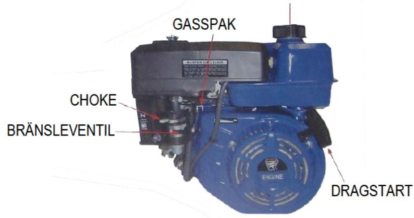
1. Öppna bränsleventilen genom att vrida den till höger. Stäng choken genom att vrida den till vänster. OBS! Om motorn redan är het, choken behöver inte stängas. Öppna gasspaken genom att vrida den till vänster (mot haresymbolen).
