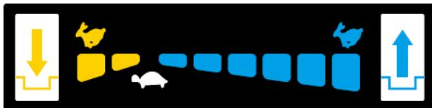
På växelpaken har 8 lägen. 6 växlar framåt och 2 bakåt. För att skifta växel, för spak till önskade lägen. Spaken låses på plats med en låsspärr för varje växel.
