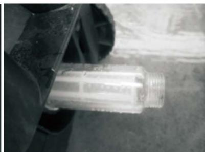
6. Fäst inloppets skruv i bild 3 till filtret andra ända.
