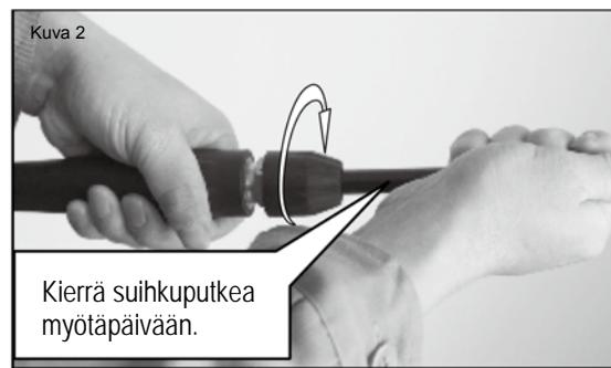
**Pistoolin ja siphonputken liittäminen:** Liitä siphonputki pistooliin (ks. kuva 1) ja kierrä siphonputkea myötäpäivään, kunnes se asettuu kuvan 2 osoittamaan asentoon. Testaa liitintä vetämällä siphonputkea. Siten voit varmistaa, ettei se irtoa ja aiheuta vahingon vaaraa.
