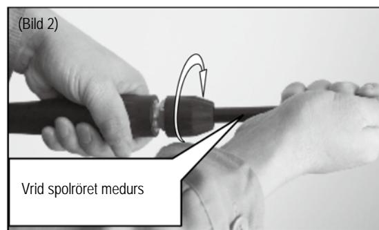
**Anslutning av pistolen och spolrören:** för in spolrören i pistolen som i bild 1 och vrid spolrören medurs tills det når läget enligt bild 2. Var god prova därefter anslutningen genom att dra i spolrören för att undvika bortkoppling och risken för olyckor.
