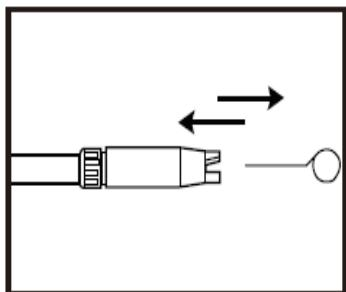
Om munstycket är helt eller delvis blockerat kan trycket i vattenstrålen minska och leda till att maskinen vibrerar eller stoppar. Var god rensa det blockerade munstycket enligt följande anvisningar:
