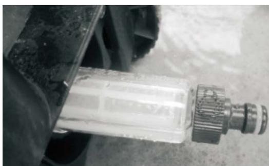
7. Anslut inloppsslangen till inloppets skruv
