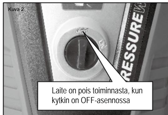
**Kytimen käyttö:** Kytke laite päälle käänämällä kytkin ON-asentoon ja pois päältä käänämällä kytkin OFF-asentoon. Tarkista ennen laitteen käytämistä, että kytkin on OFF-asennossa.
