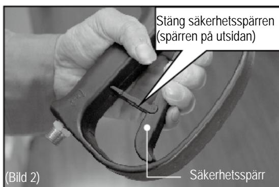
**Säkerhetsspärrens användning:** tryck säkerhetsspärren inåt och trycka in avtryckare (se bild 1); Släpp avtryckaren och tryck säkerhetsspärren utåt för att spärra avtryckaren (se bild 2).
