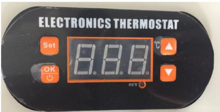
Laita reaaliaikaisen lämpötilan ilmoittava lämpömittari päälle painamalla "OK".
