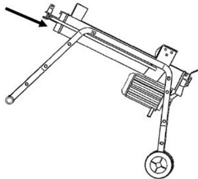
Tarkasta öljyn pinnan taso säännöllisesti varmistaaksesi, että se pysyy kahden mittatikussa olevan uran välissä. Jos öljyn pinta on liian alhaalla, öljyn lisääminen on tarpeen.
