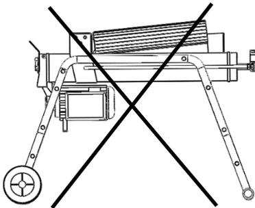
Klyv vedträet i fiberriktningen. Lägg inte vedträet på tvären för att försöka kapa det. Detta är farligt och kan ge maskinen svåra skador. Försök inte heller att klyva två vedträn samtidigt. De kan kastas upp och skada dig.
