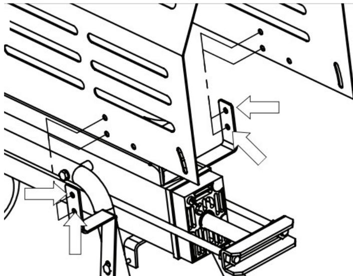
Kiinnitä sivusuojus laitteeseen 2 kappaleella kuusiopultteja M8x16, tiivisteitä  $\varnothing 8$  ja lukkomuttereita M8, sekä 4 kappaleella kuusiopultteja M6x12.
