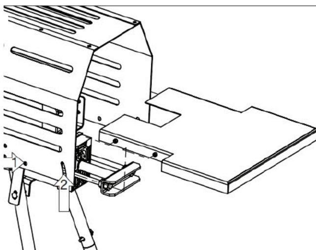
Montera vedmottagaren på skyddsburet med 2st sexkantbultar M6x12, tätningar Ø6, låsmuttrar M6 och med 2st knoppar och tätningar Ø6.
