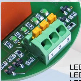
Im Grundzustand sind alle LEDs (4 Leds ) nicht bestromt. Sobald die Luftfeuchtigkeit im Raum auf >40 % steigt, leuchtet die erste LED (von rechts nach links).
