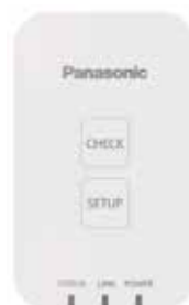
Wifi-sovitin CZ-TACG1 asennetaan pumpun sisään tai viereen.
